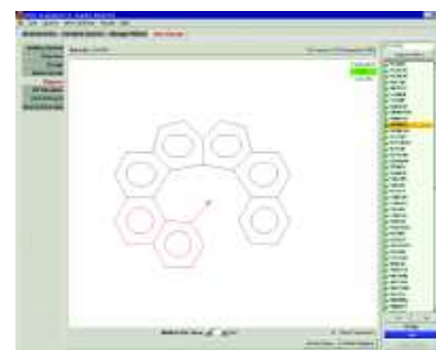
图5：结果显示界面，用于快速扫描所得结果，目标亚结构显示为红色
